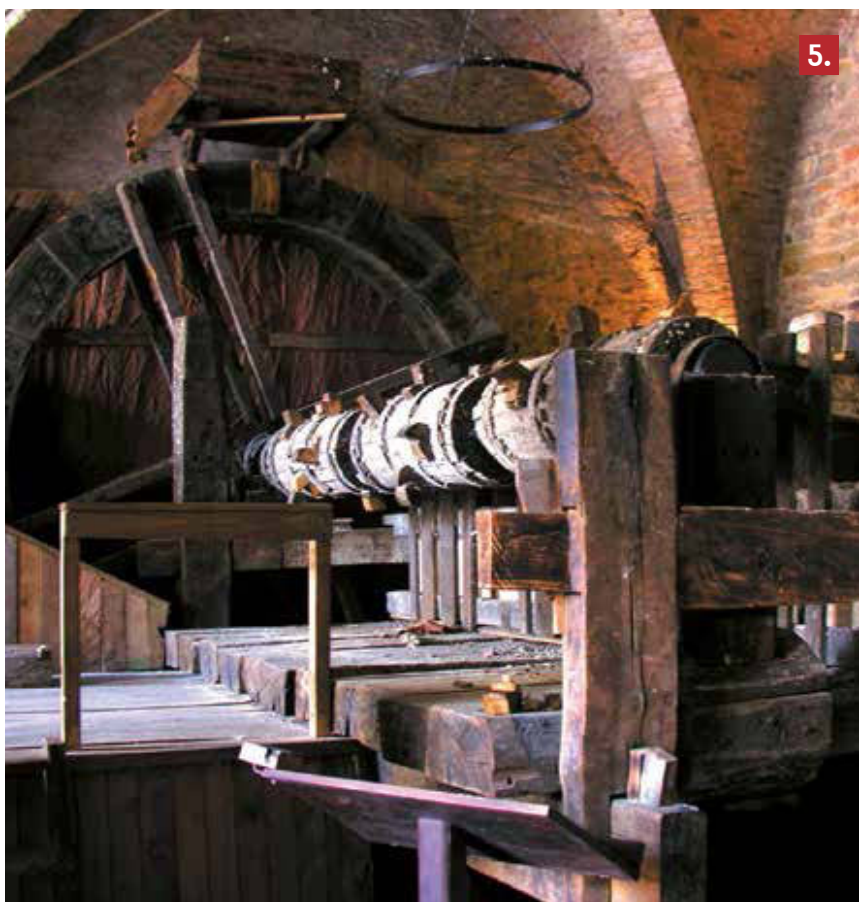
5. Antica macchina per sfibrare gli stracci, azionata dalla forza della ruota di un mulino.
