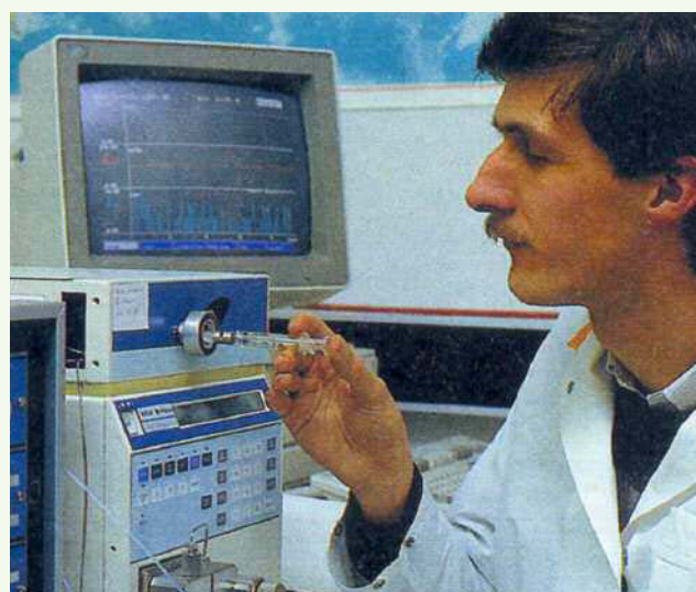
4. Gas cromatografo: si rilevano quantità molto ridotte di sostanze.
