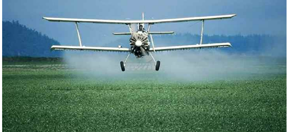
Fig. 1. Un aeroplano specializzato mentre irrori un campo con pesticidi in forma nebulizzata.
