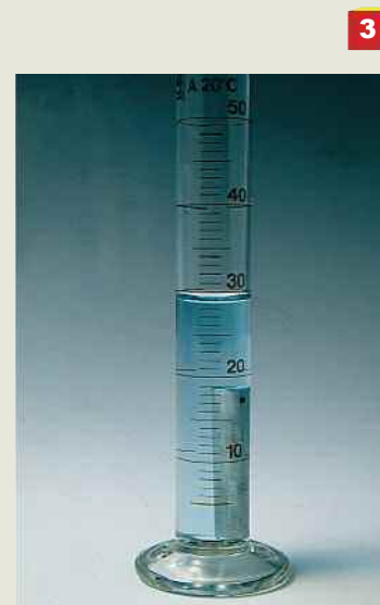
Fig. 2. Un campione di alluminio è immerso nell'acqua del cilindro.
