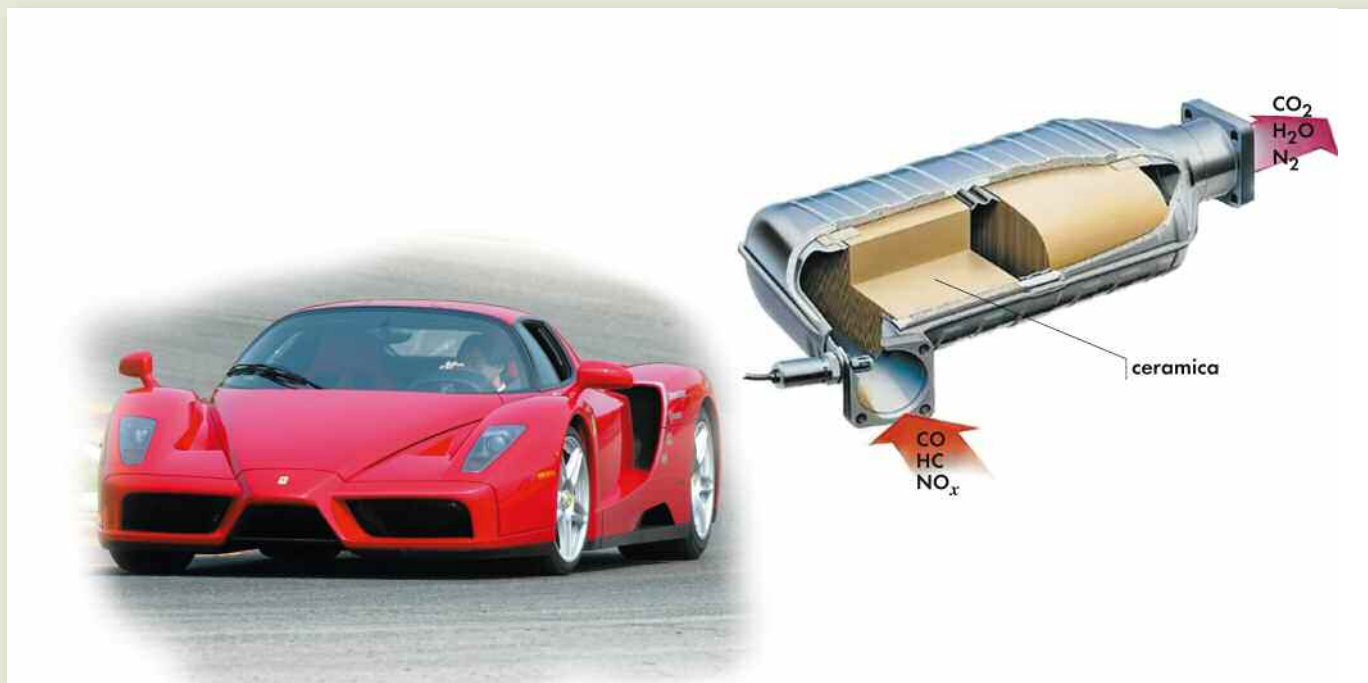
Fig. 1. Rappresentazione schematica di una marmitta catalitica.
