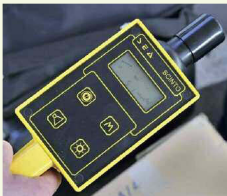
Fig. 1. Il contatore Geiger capta e misura le radiazioni emesse dai radioisotopi.
