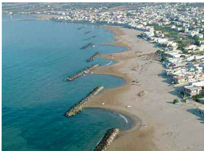
Fig. 1. Frangiflutti per la salvaguardia della spiaggia disposti lungo la costa di Donnalucata (frazione del comune di Sciacca, Ragusa).
