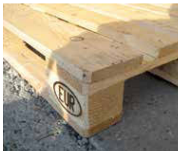
Particolare di un pallet : da notare lo spazio entro cui vanno infilate le leve di sollevamento.
