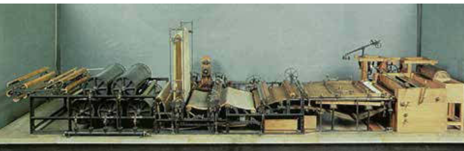
Modello di una delle prime macchine per la fabbricazione di un foglio continuo di carta, avvolto su bobine.
