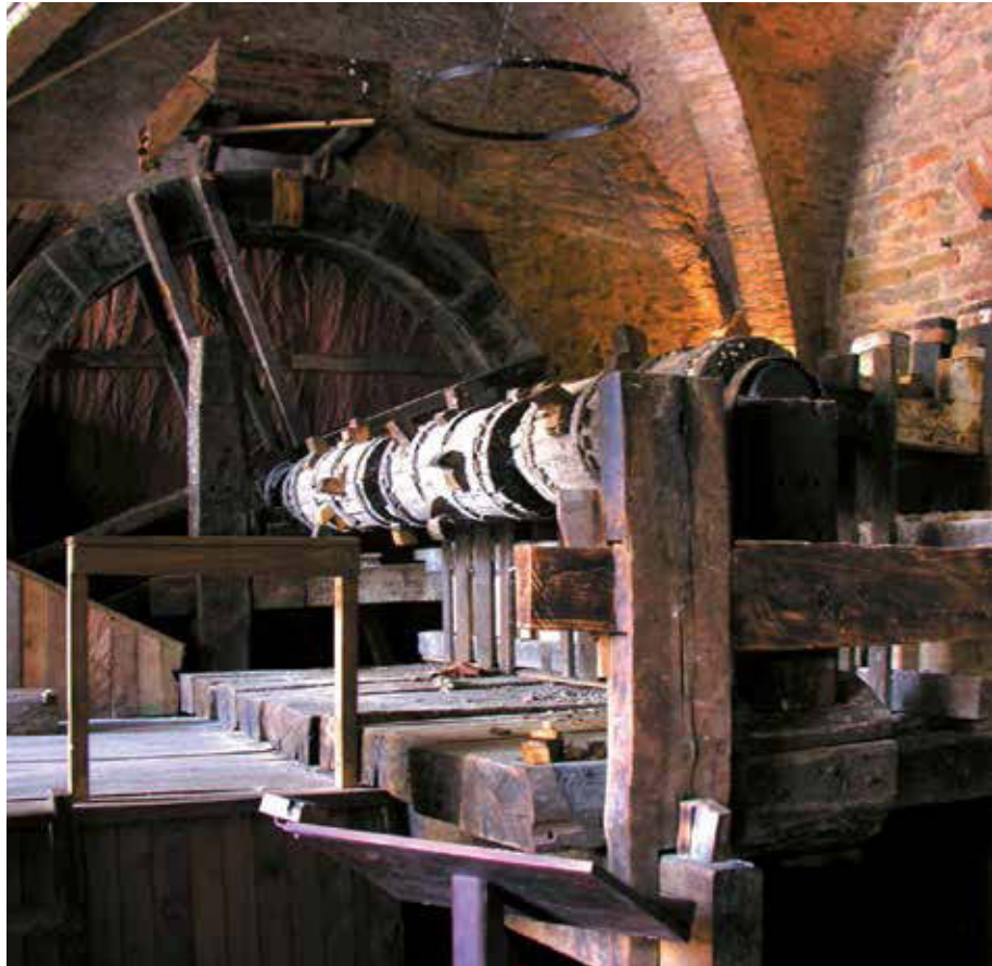
Antica macchina per sfiabrare gli stracci, azionata dalla forza della ruota di un mulino.
