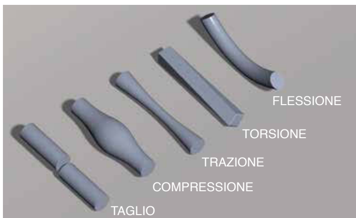
Deformazione di campioni di materiali sottoposti alle varie prove di resistenza.
