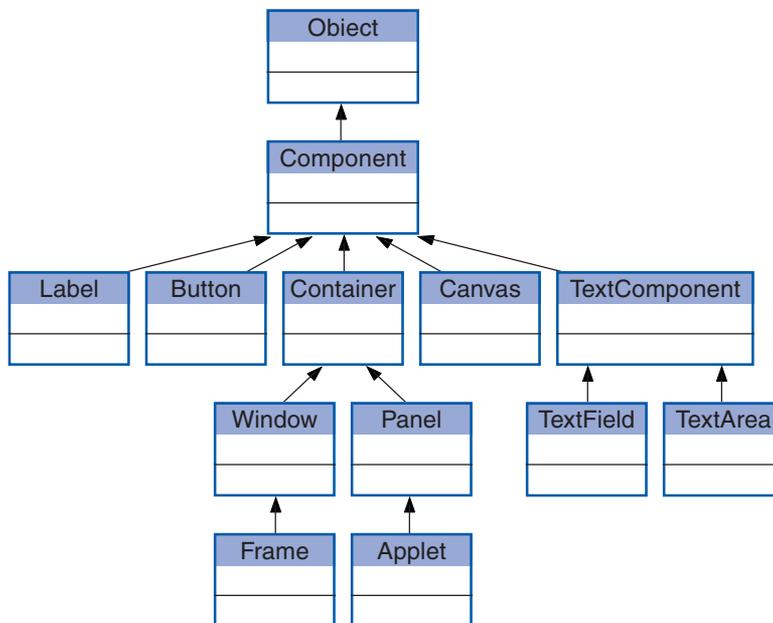
I quattro contenitori in AWT sono rappresentati dalle sottoclassi della classe **Container**: *Window* e *Frame*, *Panel* e *Applet*.
