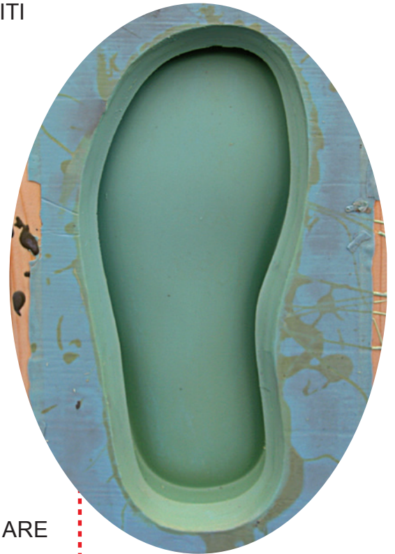
MODELLO IN SILICONE PER LA FABBRICAZIONE DI UNA MATRICE IN NICHEL PER SCARPE.
