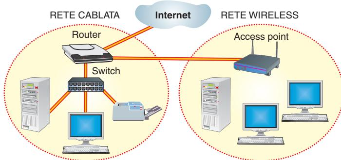
Quando tutti i dispositivi sono stati dotati di interfaccia di rete, occorre un dispositivo che permetta di creare la rete a livello fisico, cioè collegare attraverso cavi le varie interfacce di rete. Questi particolari dispositivi sono descritti nel Paragrafo 9.
