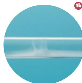
Obiettivo di questo esperimento è dimostrare che i diversi gas sono costituiti da particelle che si muovono con differente velocità.
