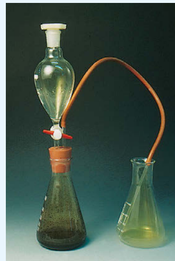
1. Materiale necessario per la preparazione del cloro da HCl concentrato e \text{KMnO}_4 .
