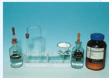
2. Materiale necessario per la preparazione del diossido di carbonio.
