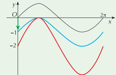
**Per individuare l'esatto ordine di applicazione delle diverse trasformazioni** devi seguire l'ordine delle operazioni; nel caso della nostra funzione: dato  $x$ , prima si calcola  $\sin x$  (funzione base), poi si calcola  $2 \sin x$  (dilatazione di fattore 2), poi si calcola  $2 \sin x - 1$  (traslazione di vettore  $\vec{v} = (0, -1)$ ).
