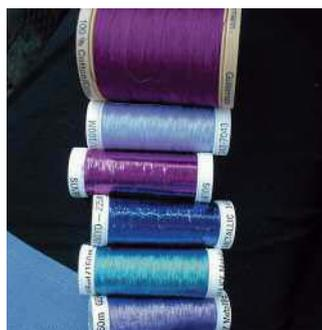
31. Filati in poliestere: il para-xilene è il materiale di partenza per la preparazione di fibre poliestere.
