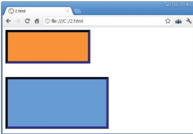
Nel caso del primo box, per desumere la dimensione effettiva non è necessario sommare i valori di *border* e *padding* a quelli della larghezza perché è presente la proprietà *box-sizing* con valore *border-box*: la larghezza del *div* è di 250px.
