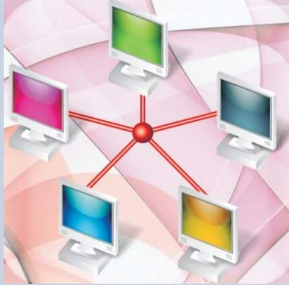
Il dispositivo di rete utilizzato nella modalità passiva si chiama **hub**: esso identifica un'apparecchiatura fisica che assolve alle funzioni di collettore e di concentratore dei cavi provenienti dai vari sistemi connessi in rete.
