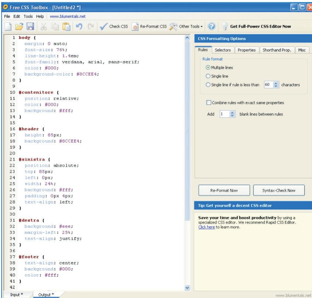
Il software dispone di un comodo strumento di correzione del codice. Facendo clic sul pulsante **Check CSS** viene visualizzata una finestra nella quale è possibile scegliere il tipo di validazione (in base al tipo di browser o alle specifiche del codice).
