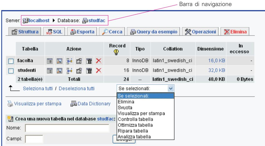
Si noti, nel frame principale, una *barra di navigazione* che indica il percorso seguito per arrivare al database *StudFac* e la barra dei comandi con i pulsanti **Struttura**, **SQL**, **Esporta**, **Cerca**, **Query da progetto**, **Operazioni** ed **Elimina**, che attivano funzioni relative all'intero database.
